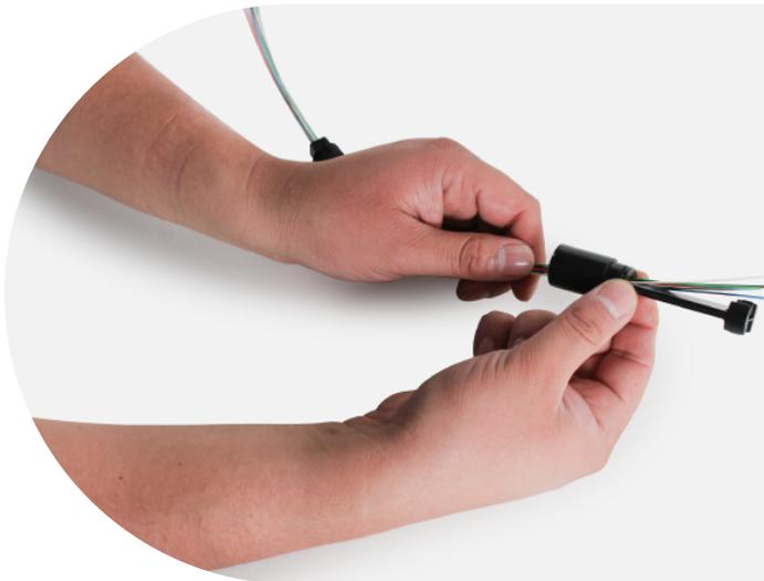
**PASO4:** Se inserta el housing en el cable para poder enroscarlo con la tuerca longitud
