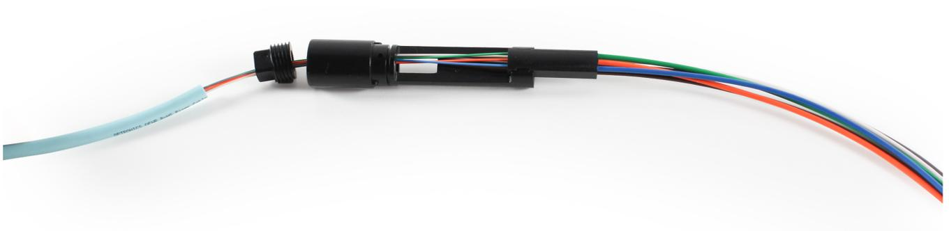
**PASO 7:** Se coloca la cubierta de forma que los orificios para los tornillos acoplen con los orificios del housing
